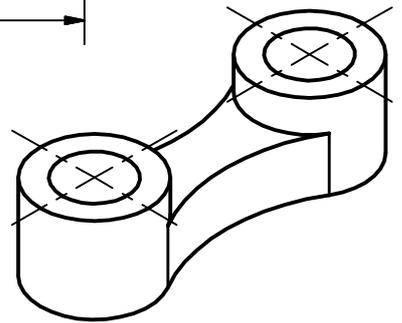
Inhalt / Übungsziel: Abhängigkeiten in Skizze; Geometrische- und Bemaßungsabhängigkeiten; Skizze voll bestimmt..
