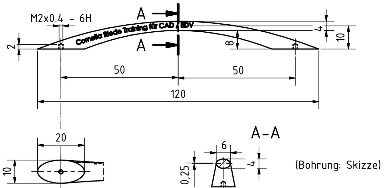
Inhalt / Übungsziel: Sweep, Erheben, Bohrung, Gewinde, Ebenen, Spiegeln.
